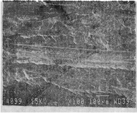
图27 A 3 钢中磨痕的粗大犁沟
